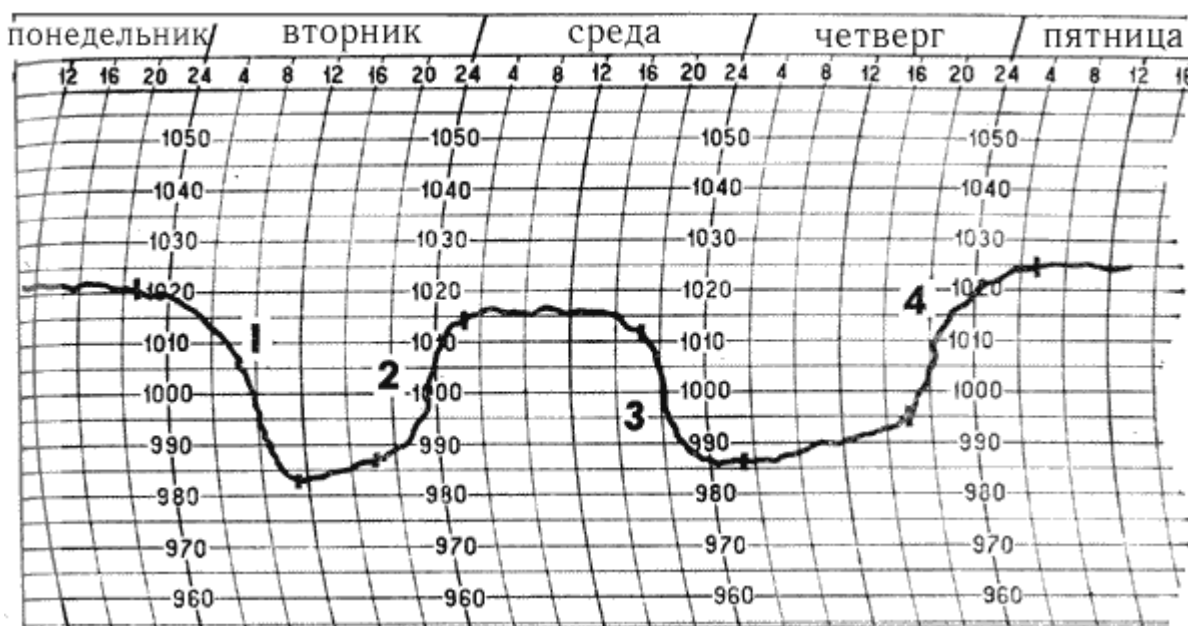
Рис. 111. Примеры барических тенденций. Кривая выпуклостью вверх: при падении давления - значительное ухудшение погоды (1), при повышении - к улучшению погоды (4). Кривая выпуклостью вниз: при падении давления - ослабление ветра, некоторое улучшение погоды (3); при повышении - может усилиться ветер (2)
