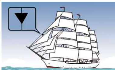
Вид днем на судно, идущее под парусом и в то же время приводимое в движение механической установкой (правило 25 (е))
