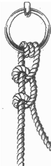
Рис. 13. Простой штык с двумя шлагами
