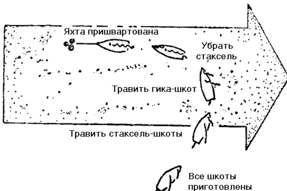
Рис. 165. Приведение к ветру при швартовке
