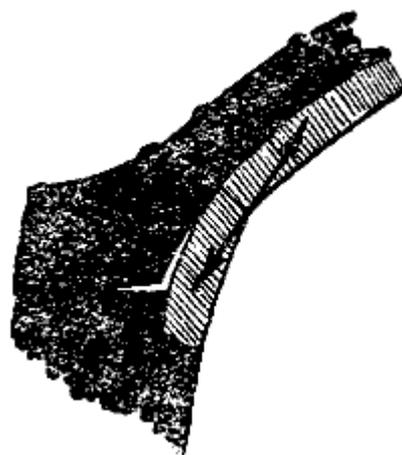
Рис. 131. Если пояса обшивки при разбухании не имеют возможности расширяться, то они поворачиваются относительно друг друга и поднимают поперечные связи
