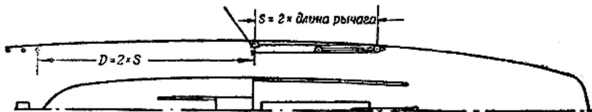
Рис. 326. Расположение приспособления для переключивания бакштагов у кокпита
