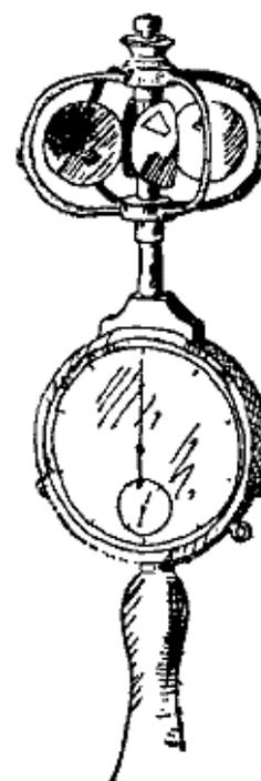
Рис. 181. Прибор для измерения скорости ветра (анемометр)
