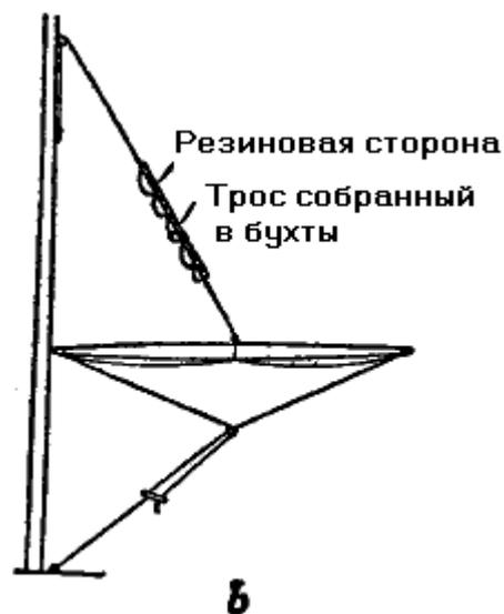
Рис. 307 б. Эластичный топенант с резиновой стропой
