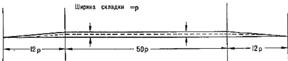
Рис. 38. Относительные размеры складки: постоянная ширина складки должна по длине быть примерно в 50 раз больше, чем полная ее ширина. Законцовки должны быть длиной не менее 12 ширин складки
