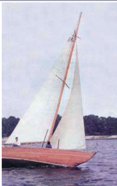
Яхта имеет дробную оснастку типа шлюп. Это означает, что стаксель-штаг закреплен на мачте ниже топа.
