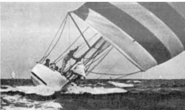
После поворота фордевинд яхта начала уходить в брочинг, возможно, в результате того, что гика-шкот перебран. Установка завал-талей.
