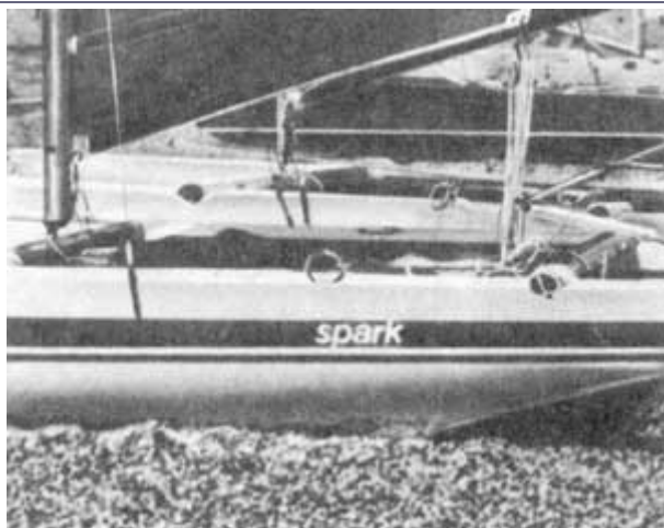
На небольшом легком катамаране "Спарк" грот поставлен без гика.
