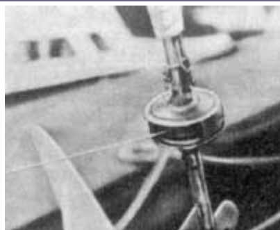
Натяжение тросика обеспечивает вращение барабана и закручивание стакселя.
