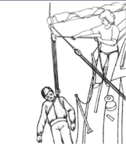
Чтобы поднять человека из воды, тали оттяжки гика крепят при помощи скобы на ноке гика.
